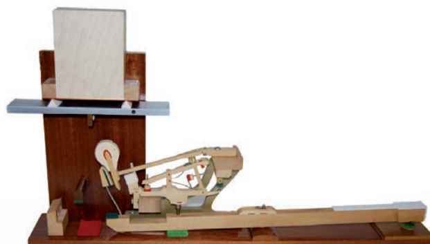
Die Mechanik eines Tastenglockenspiels mit Flügelmechanik
